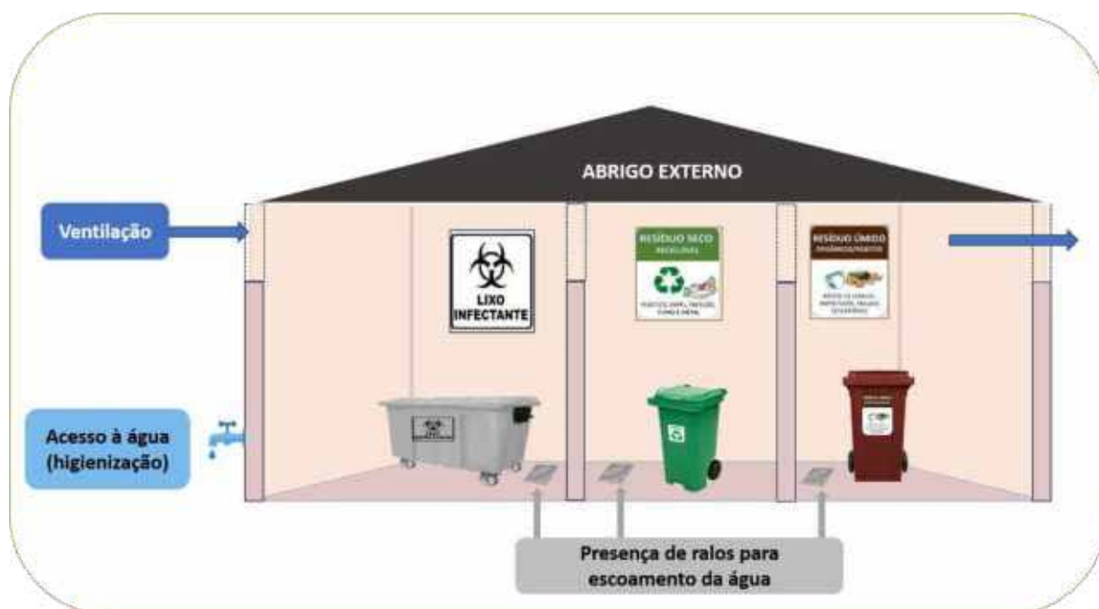
Figura 99. Exemplo ilustrativo de armazenamento externo
